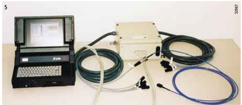
Bild 5 Faseroptisches Messsystem, bestehend aus PC für Datenverarbeitung und -anzeige, faseroptischen Sensoren mit Kabeln und Energieversorgung
